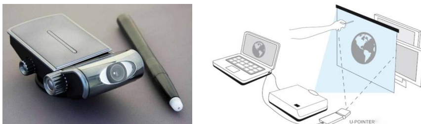
Фигура 8. Мобилна интерактивна дъска, тип интерактивно устройство (уеб камера) - U-pointer, вляво интерактивната дъска, а вдясно конфигурацията ѝ
