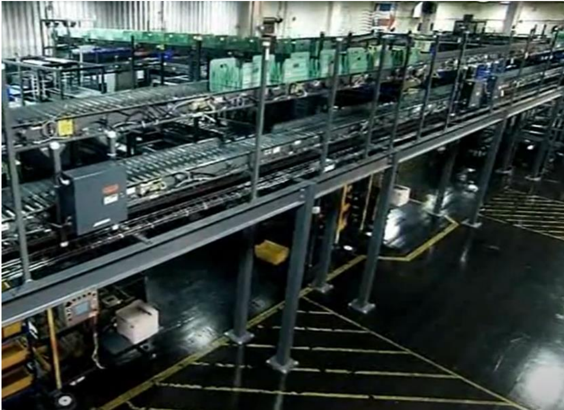
Фиг. 75 Входяща част от конвейер в център за сортиране на пратки
