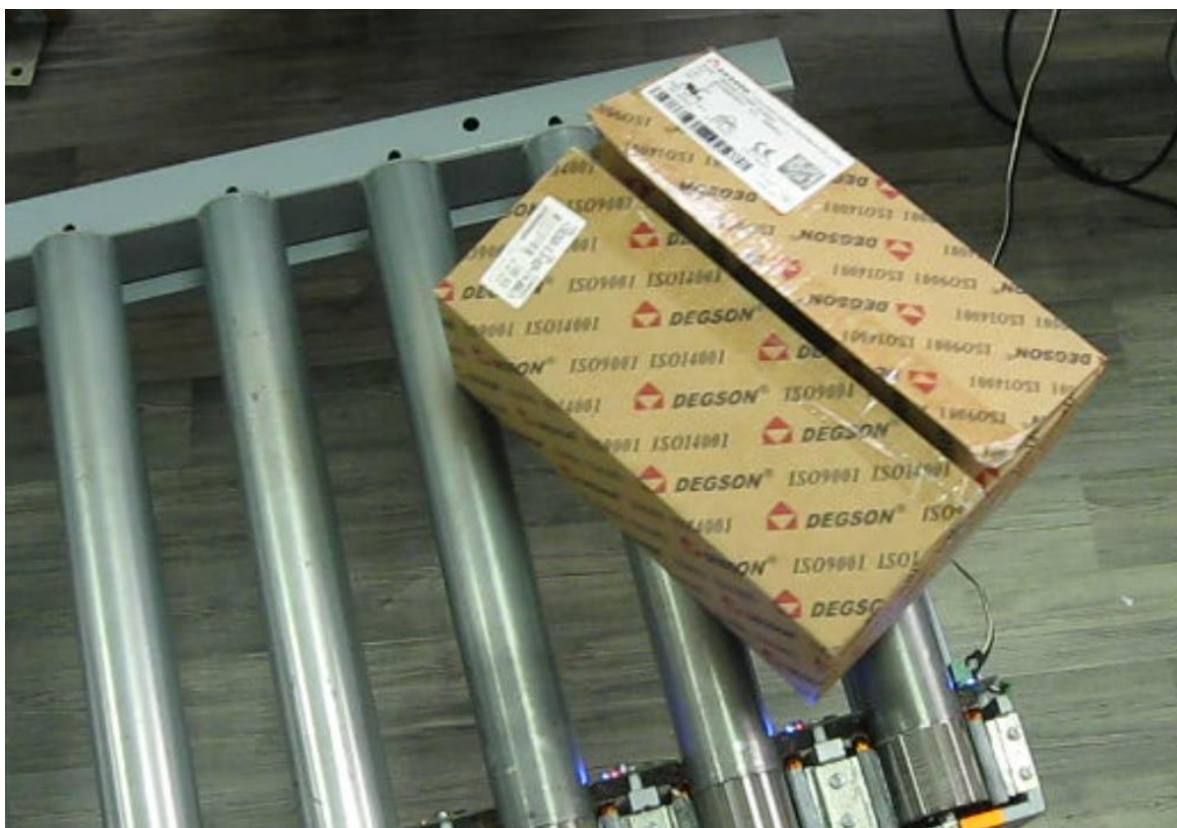
Фиг. 63 Безсензорен конвейер с безсензорни БЧПТ мотори.
