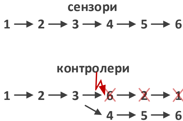
Фиг. 37 Ефект от приемането на следващата по посока на въртене информация при получаване на грешна такава.
