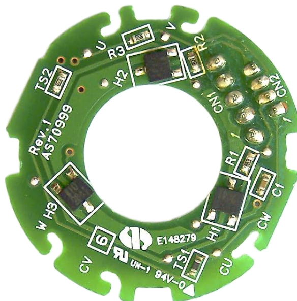
Фиг. 13 Датчици на Хол монтирани на печатна платка
