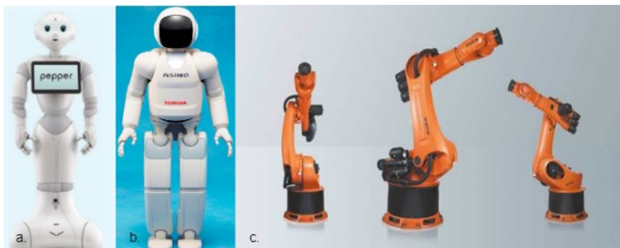
Фиг. 1.1. Видове роботи: а. Мобилен антропоморфен робот Pepper [26]; б. Крачещ робот Asimo [27]; в. Индустриален манипулатор KUKA 500 Fortec.
