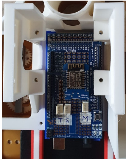
Фиг. 4.12. Сглобената управляваща електроника на робота.
