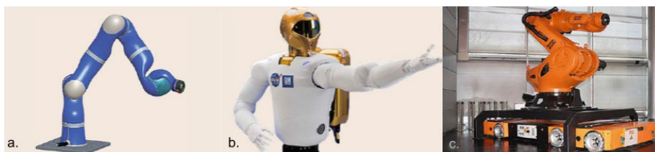
Фиг. 1.4. Антропоморфни роботи с допълнителни степени на свобода [35]: a. DLR (Deutsches Zentrum für Luft- und Raumfahrt); b. робот NASA Robonaut; c. мобилен манипулатор KUKA.
